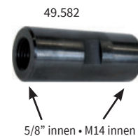
49.582 5/8" innen • M14 innen Somit kann ein HEXAFIX-Rührwerk für normale M14-Rührer umgerüstet werden. HEXAFIX-Schnellkupplung am Rührwerk abschrauben, 5/8"-Anschluß draufschauben, M14-Rührer einschrauben - fertig.
