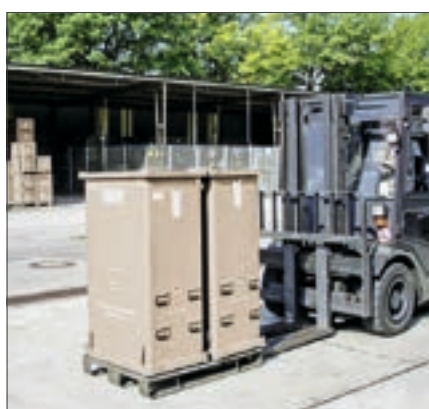
Palettenunterbau vereinfacht das Handling
