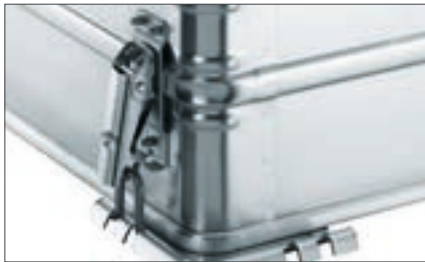
Schnellverschluss bei abnehmbarer Pritschenbox
