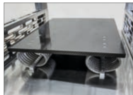
Aufnahmetisch, schwingend gelagert mit Gummipuffer oder Drahtseildämpfer
