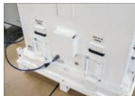
Wasserdampfdichter Behälter bei Dichtheitsprüfung durch Überdruck
