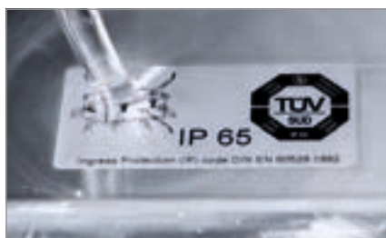
Strahlwasserschutz nach Norm IP 65
