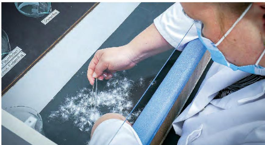
**Fleißarbeit.** Im Labor sortiert eine Mitarbeiterin die Bettfüllung nach Daunen, Federn und Bruch. So lässt sich die Zusammensetzung der Decken prüfen.
