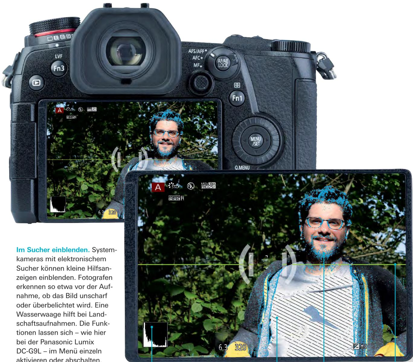
**Im Sucher einblenden.** Systemkameras mit elektronischem Sucher können kleine Hilfsanzeigen einblenden. Fotografen erkennen so etwa vor der Aufnahme, ob das Bild unscharf oder überbelichtet wird. Eine Wasserwaage hilft bei Landschaftsaufnahmen. Die Funktionen lassen sich – wie hier bei der Panasonic Lumix DC-G9L – im Menü einzeln aktivieren oder abschalten.
