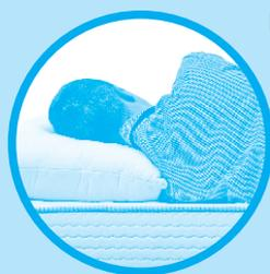
**Schwitzen und wälzen.** In der Klimakammer belasten wir die Matratze mit Gewicht, Wärme und Feuchte, mit der Dauerwalzprüfung simulieren wir zigtausende nächtliche Umdrehungen. Die Walze machte keiner Matratze viel aus. Die Klimakammer erweichte Möbel Höffner und Schlaraffia am stärksten, Rummel und Selecta verloren am meisten an Höhe.
