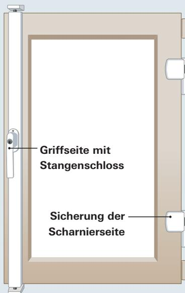
**Balkontüren brauchen mehr.** Eine vertikale Stange schützt die Griffseite, eine Sicherung pro Meter Höhe die Scharnierseite.
