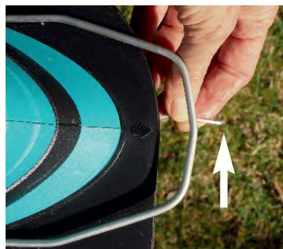
**Schutzlos.** Der Drahtbügel vom Bosch ART 27 ist zurückgerutscht, sodass der Faden hervorragt und Blumen kappen kann.
