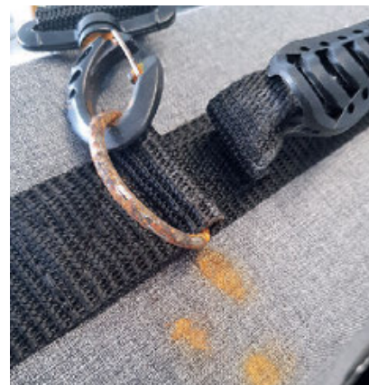
Korrosion. Nach der Prüfung im Salzsprühnebel hatte die Citytasche von Haberland Rostrost angesetzt.
