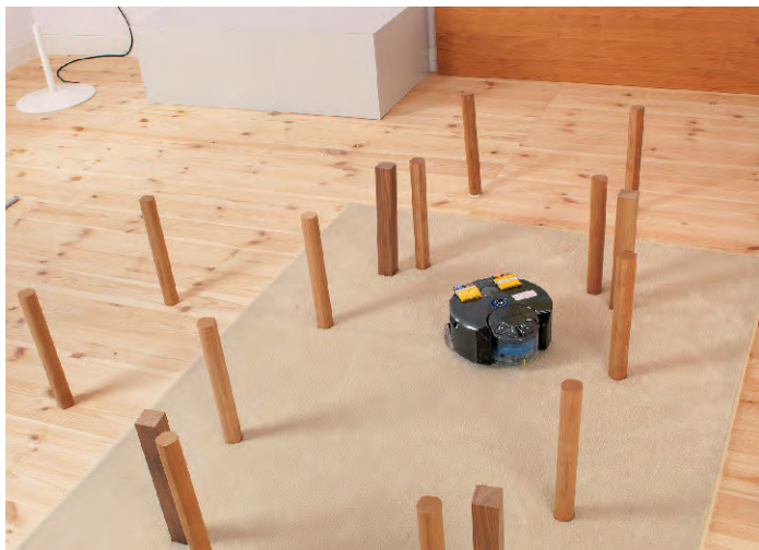
Prüfraum. Hier müssen die Sauger möglichst viel Fläche saugen, Stuhl- und Tischbeine eng umrunden.
