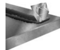
Konventionelles Korn ist unregelmäßig und hat eine eher blockige Form, die zu einer pflügenden Wirkung führt und beim Schleifen eine unerwünschte Wärme erzeugt.
