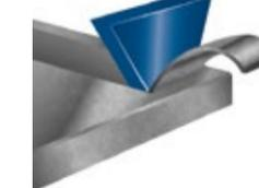
Die optimale dreieckige Form des Bosch Prisma Technology Korns hingegen ermöglicht einen sauberen Schnitt für schnellsten Abtrag und geringere Schleiftemperatur, was zu einer längeren Lebensdauer der Scheibe führt.
