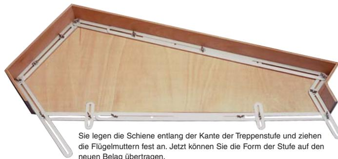
Sie legen die Schiene entlang der Kante der Treppenstufe und ziehen die Flügelmuttern fest an. Jetzt können Sie die Form der Stufe auf den neuen Belag übertragen.
